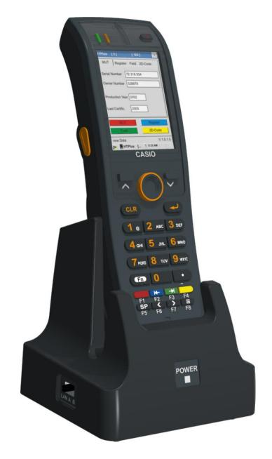
Das Handterminal HT 2010 erleichtert die Eingabe von Zählerdaten erheblich, da direkt bei den Prüflingen die Zählerdaten eingegeben werden können.
